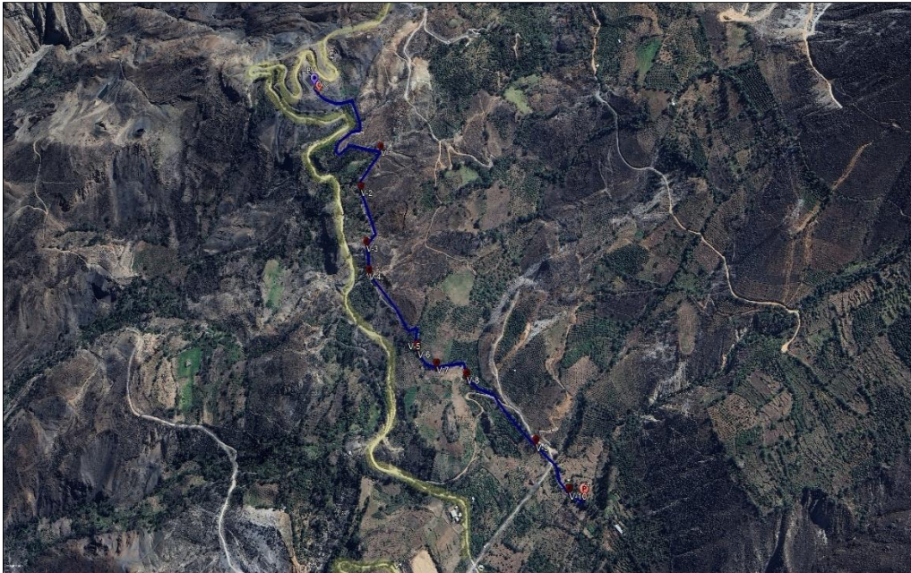
Figura N° 05: diseño de las líneas de distribución
